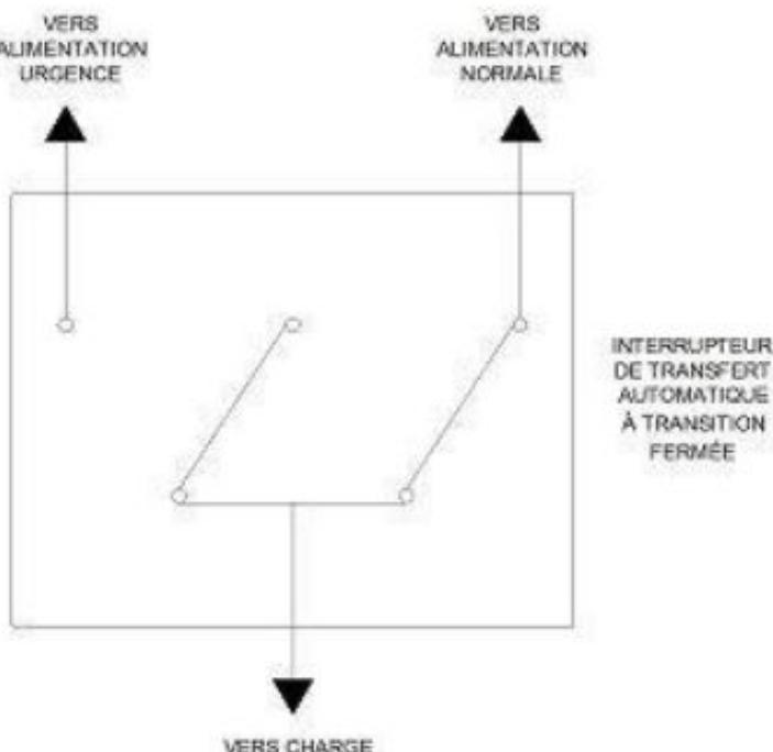
Les interrupteurs à transition fermée sont utilisés pour les charges critiques qui ne doivent pas perdre l'alimentation, même momentanément lors du retour à la source normale; par exemple dans les hôpitaux et les centres de données. C'est le type d'interrupteur de transfert le moins utilisé dû à la complexité et aux coûts élevés.
